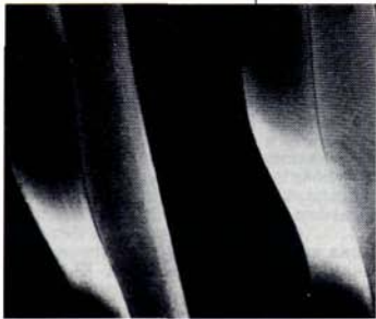
A sinistra: Ingrandimento di un solco relativo ad un disco vinilico con inciso un segnale per un solo canale. Sopra: l'ingrandimento riguarda un solco con inciso un segnale particolarmente complesso.
