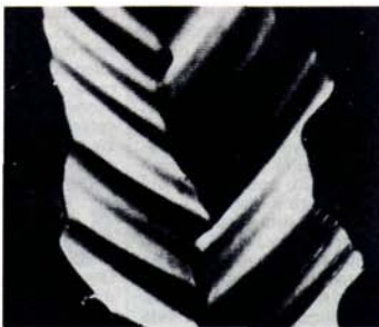
A sinistra: Ingrandimento di un solco relativo ad un disco vinilico con inciso un segnale per un solo canale. Sopra: l'ingrandimento riguarda un solco con inciso un segnale particolarmente complesso.
